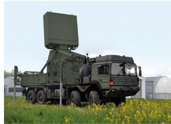
Das Radar TRML-4D erkennt 1500 Ziele in einem 250 Kilometer-Radius.
