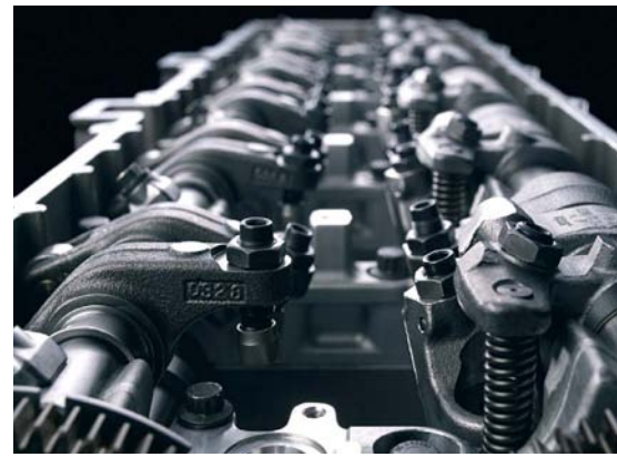
Arbeitet im Daimler-Motor ähnlich virtuos wie ein Pianist auf der Klaviatur: Der von der Maschinenfabrik Spaichingen gefertigte Ventiltrieb.
