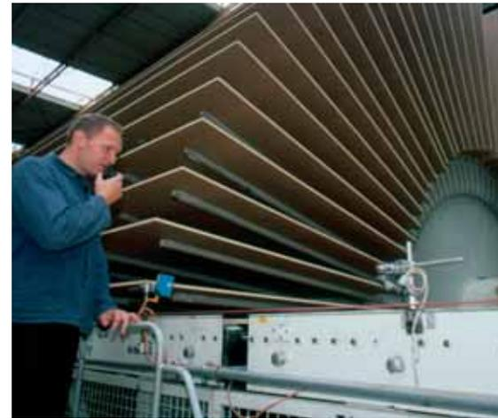
In einem Kühlstermender kühlen die Spanplatten nach dem Pressvorgang von 110 auf rund 60 Grad Celsius ab.
