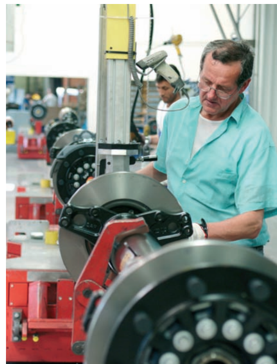
Mit scheibengebremsen Achsen für LKW-Anhänger hat sich die Otto Sauer Achsenfabrik eine führende Marktposition in Europa erarbeitet. Das Bild zeigt die Montage einer scheibengebremsen Achse im Werk Bessenbach (bei Aschaffenburg/Bayern).
